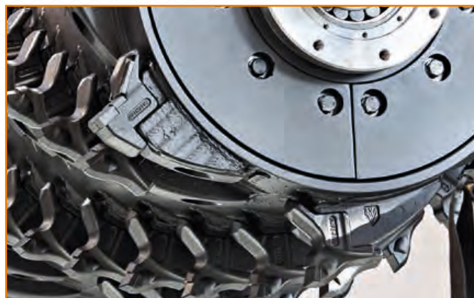
Держатели зубьев из высокопрочной стали с боковой защитой.
