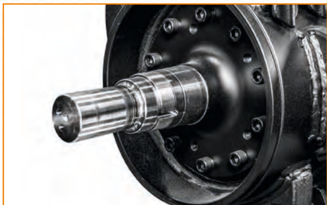
Поворотные кулаки из высокопрочной стали прикрепленные к ротору болтами.
