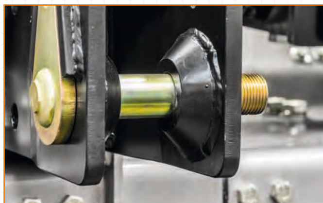
Коническое прицепное приспособление под трехточечное крепление навесного оборудования.
